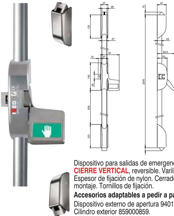
Dispositivo para salidas de emergencia accionado mediante **PLACA A PRESIÓN "PAD INOX" CORTAFUEGOS TRIPLE CIERRE VERTICAL**, reversible. Varillas y carcasas para altura máxima 2.265 mm. Resbalón de acero autoblocante. Espesor de fijación de nylon. Cerraderos para alto / bajo con espesores de 1-2 -3 mm. Plantilla. Instrucciones de montaje. Tornillos de fijación.
