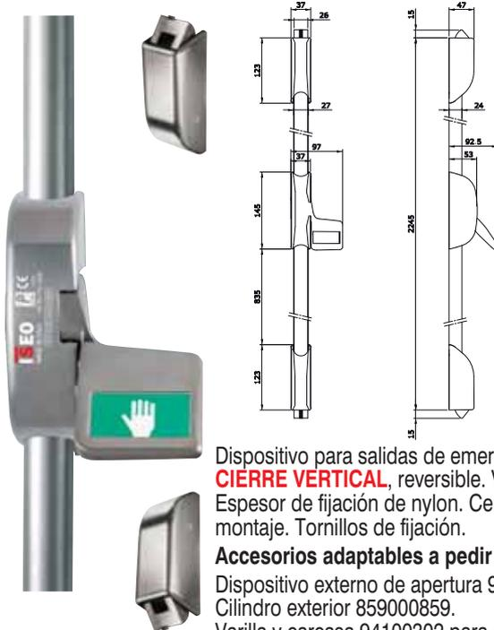
Dispositivo para salidas de emergencia accionado mediante **PLACA A PRESIÓN "PAD INOX" CORTAFUEGOS DOBLE CIERRE VERTICAL**, reversible. Varillas y carcasas para altura máxima 2.265 mm. Resbalón de acero autoblocante. Espesor de fijación de nylon. Cerraderos para alto / bajo con espesores de 1-2 -3 mm. Plantilla. Instrucciones de montaje. Tornillos de fijación.
