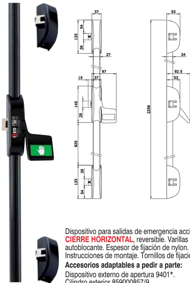
Dispositivo para salidas de emergencia accionado mediante **PLACA A PRESIÓN "PAD" CORTAFUEGOS TRIPLE CIERRE HORIZONTAL**, reversible. Varillas y carcasa para altura máxima 2.265 mm. Resbalones de acero autoblocante. Espesor de fijación de nylon. Cerradero lateral y para alto / bajo con espesores de 1-2 -3 mm. Plantilla. Instrucciones de montaje. Tornillos de fijación.
